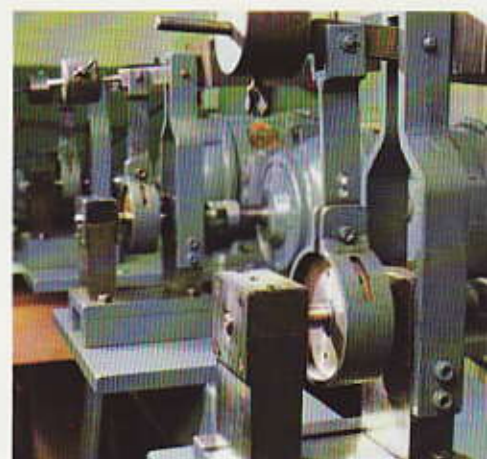
bancs d'essai pour coussinets en carbone (marche à sec)
