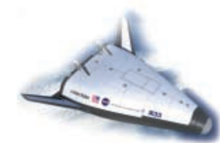
Nose cap mit Schunk-Beschichtung für den Raumgleiter CRV. Diese Beschichtung ermöglicht 120 Wiedereintritte in die Erdatmosphäre.
