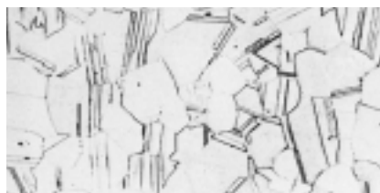
Querschliff AgCu 3 Cross section AgCu 3 Coupe transversale AgCu 3
