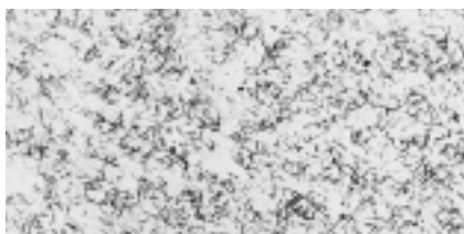
Querschliff AgNi 0,15 Cross section AgNi 0,15 Coupe transversale AgNi 0,15
