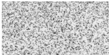
Querschliff Ag/CdO i. ox. Cross section Ag/CdO i. ox. Coupe transversale Ag/CdO i. ox.
