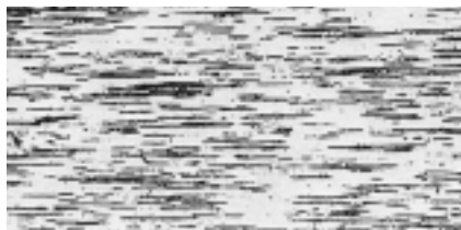
Längsschliff AgNi 10 Longitudinal section AgNi 10 Coupe longitudinale AgNi 10
